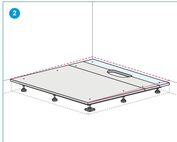
Zweiter Duschbodenteil bündig an erstes Duschbodenteil auf Montagerahmen mittig Steg verkleben und befestigen.
