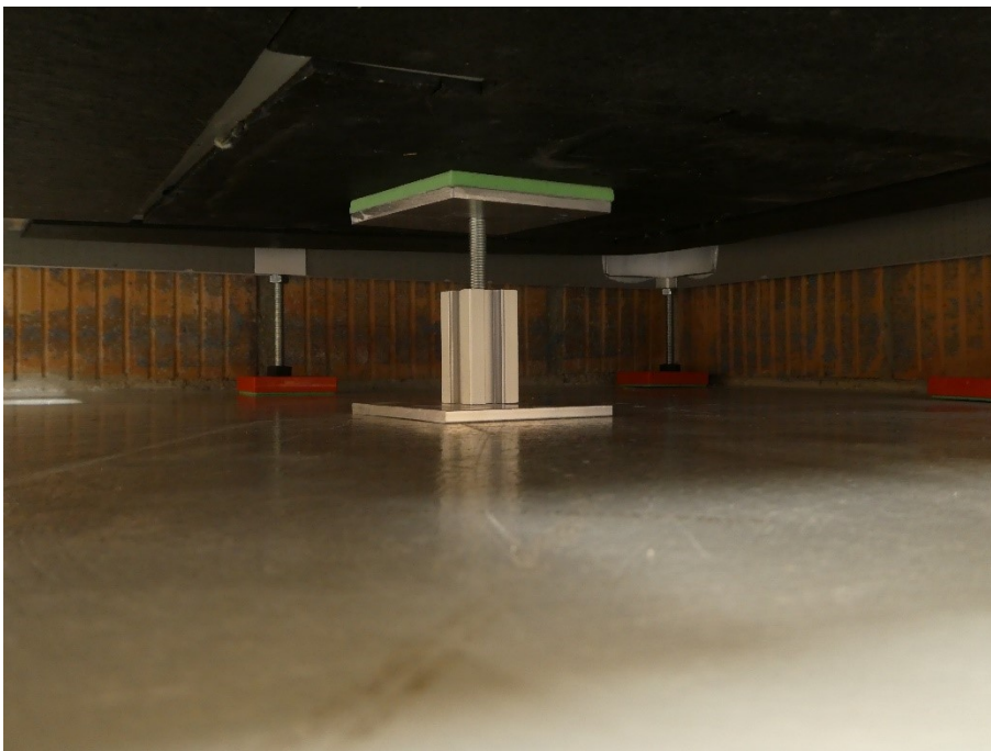
Abbildung 8: Detailansicht von Prüfaufbau 2 mit Mittelstützenfuss
